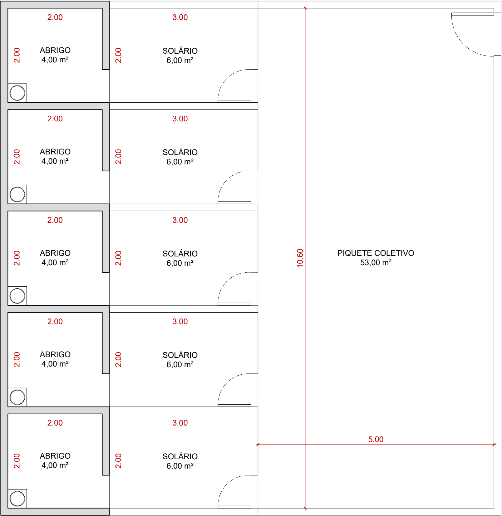
PLANTA - CONJUNTO DE BAIAS P/ CÃES DE GRANDE PORTE Escala 1:50
